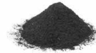
触媒層はプラチナを担持させたカーボンで構成されています。当社技術により、プラチナのサイズと配置を均等化することで、効率よく化学反応を起こし発電性能を向上させています。
