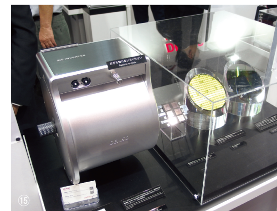
結晶欠陥を10分の1にまで低減したデンソーのSiCパワー半導体
