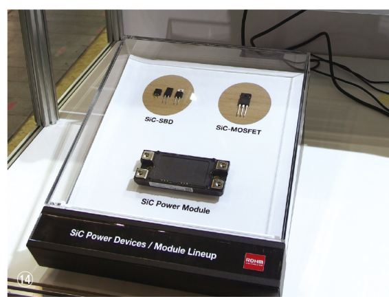
自動車の航続距離を8%伸ばせるロームの「フルSiCパワーモジュール」
